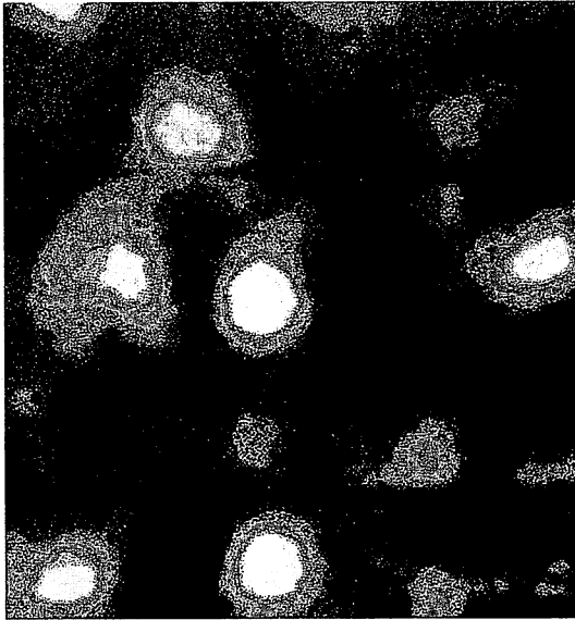
図4 InGaAs量子ドットから発光するフォトルミネッセンスの強度分布の測定結果。 画像の一边は3 \mu\text{m} 。発光波長は928nm。測定温度は5 K。
