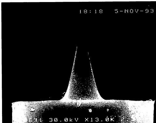
図 2 (a) 先鋭化ファイバの電子顕微鏡像。クラッドの外径は 8 \mu\text{m} 。
